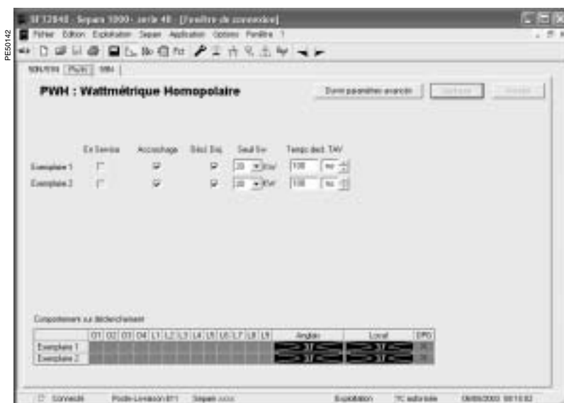
Exemple d'écran de réglage de la protection PWH.
